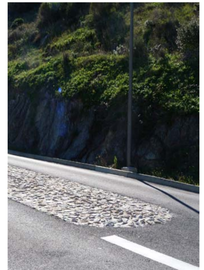
Tratamento de piso com 'rasgos' de pedra. Indicam recuo central, lateral ou parada estratégica.
